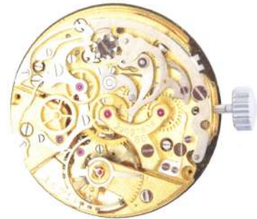
Le calibre maison 388, présenté en 1949, permettra à la marque de s'imposer sur le marché des chronographes.
